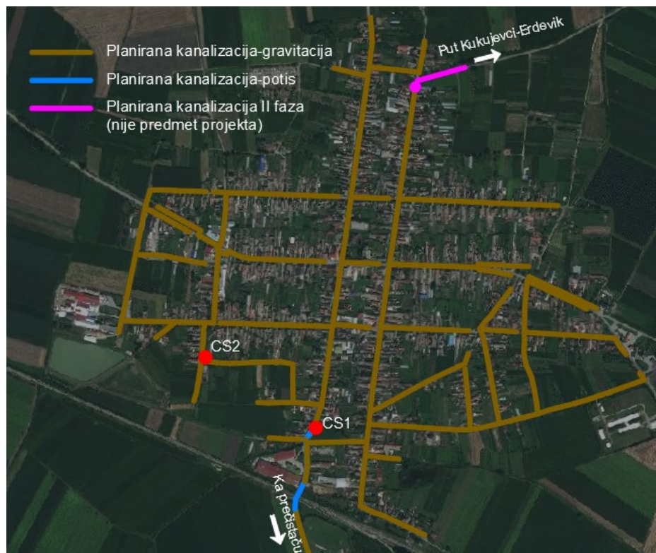
Слика 2: Планирана канализација отпадних вода насеља Кукујевци
